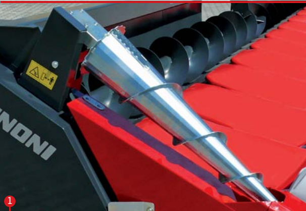
BOCZNE ŚLIMAKI STOŻKOWE Боковые конические вальцы Konusni spiralni bočni valjci Странични винтови делители
